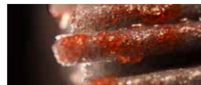
Рисунок 6б. Металлопластиковые щетки после очистки (160-кратное увеличение).
